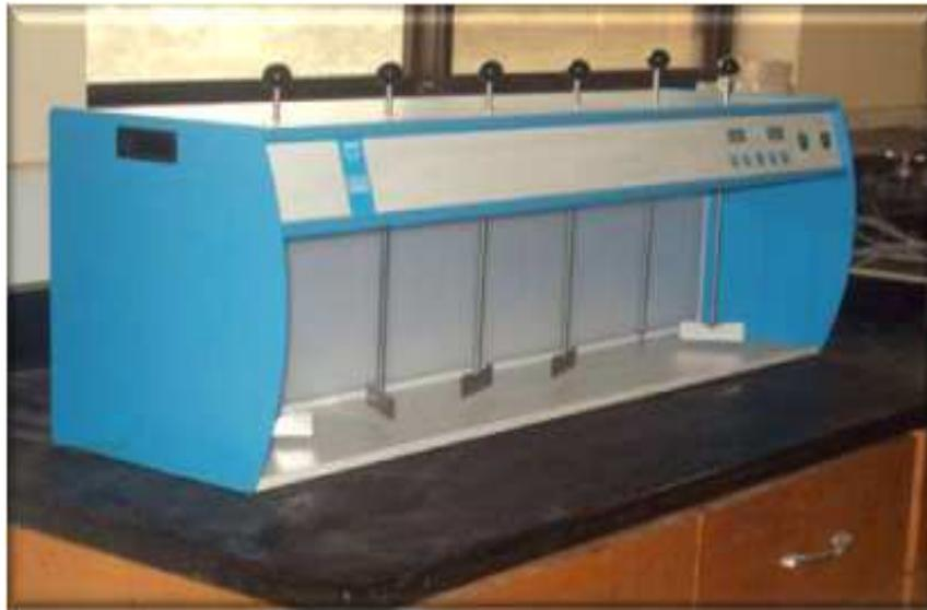
**Figure 2: Jar-Test Apparatus**
