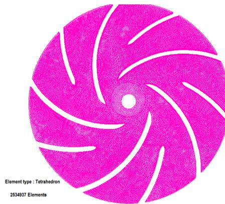
**Figure.3. Impeller Mesh**
